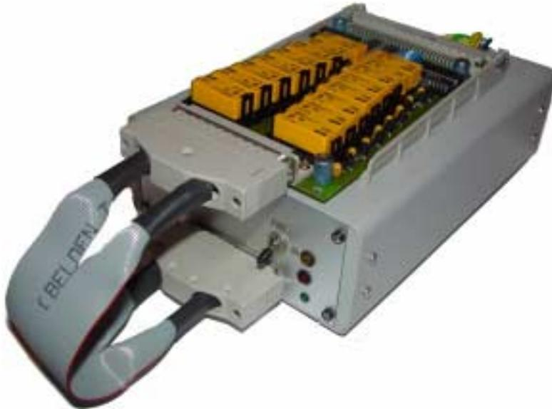
Die zu testende Platine wird über eine Kartenführung, die fest an der Oberseite des Prüfgerätes verschraubt ist, an die 64polige Leiste angesteckt. Die Schaltausgänge der Relaiskarte werden über den 37poligen SUB-D-Stecker mit der Controllereinheit des Prüfgerätes verbunden.
