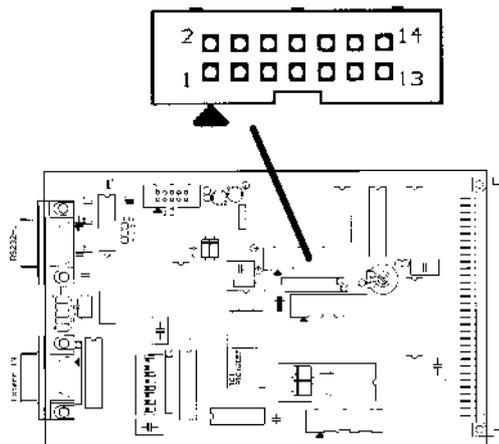
Die rote Ader des 14poligen Flachbandkabels auf Pin '1' der Tastatur legen. Ader Nr.2 liegt am Blindpin der Tastatur. Die restlichen Adern der Reihe nach auflegen.
