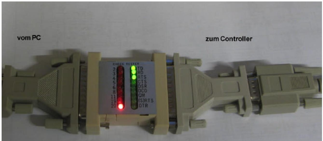
Sobald jetzt im Programm MCS-Tools die Com-Verbindung aktiviert wird, muss zusätzlich die rote LED bei DTR aufleuchten, die grüne LED bei DTR erlischt.
