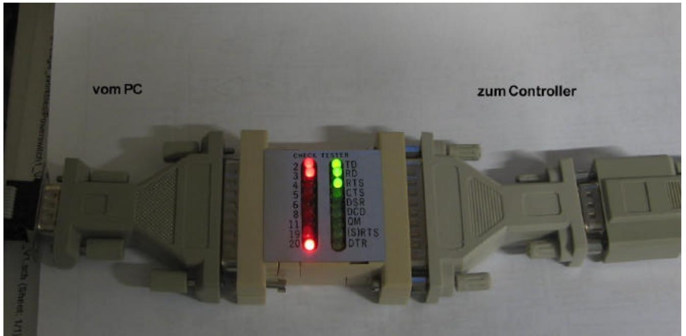
Im Programm MCS-Tools jetzt den Segment-Test aktivieren. Hier werden ständig Daten zwischen dem PC und dem Controller hin- und hergeschickt. Also Folge leuchten die beiden roten LEDs bei TD und RD mit auf.
