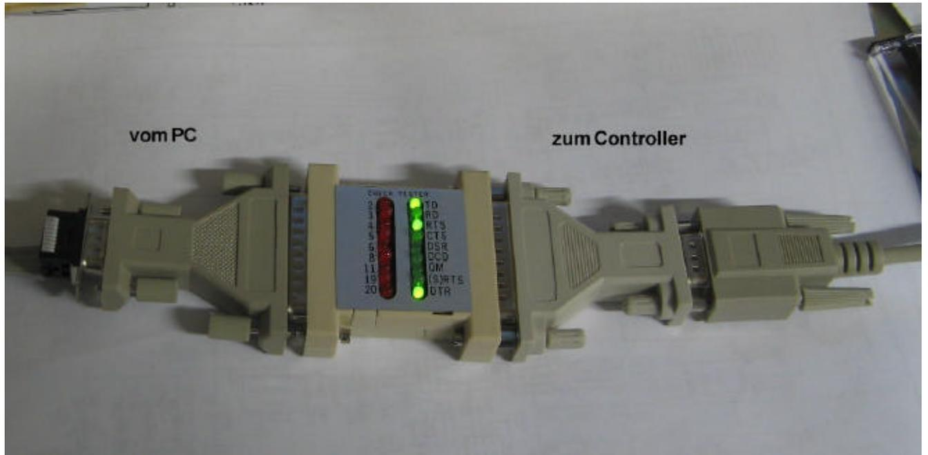
Beim Testprogramm (MCS-Tools) darf noch nicht die serielle Schnittstelle aktiviert worden sein. Am Teststecker leuchten nur die beiden grünen LEDs "TD", "RTS" und "DTR".
